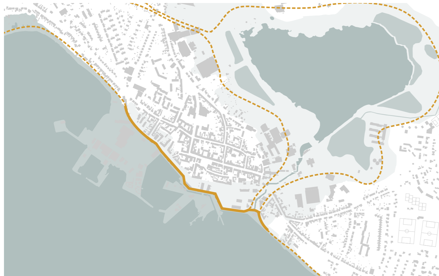
Med en højvandsikring, der følger den oprindelige kystlinje, vil byen være beskyttet mod oversvømmelse.
