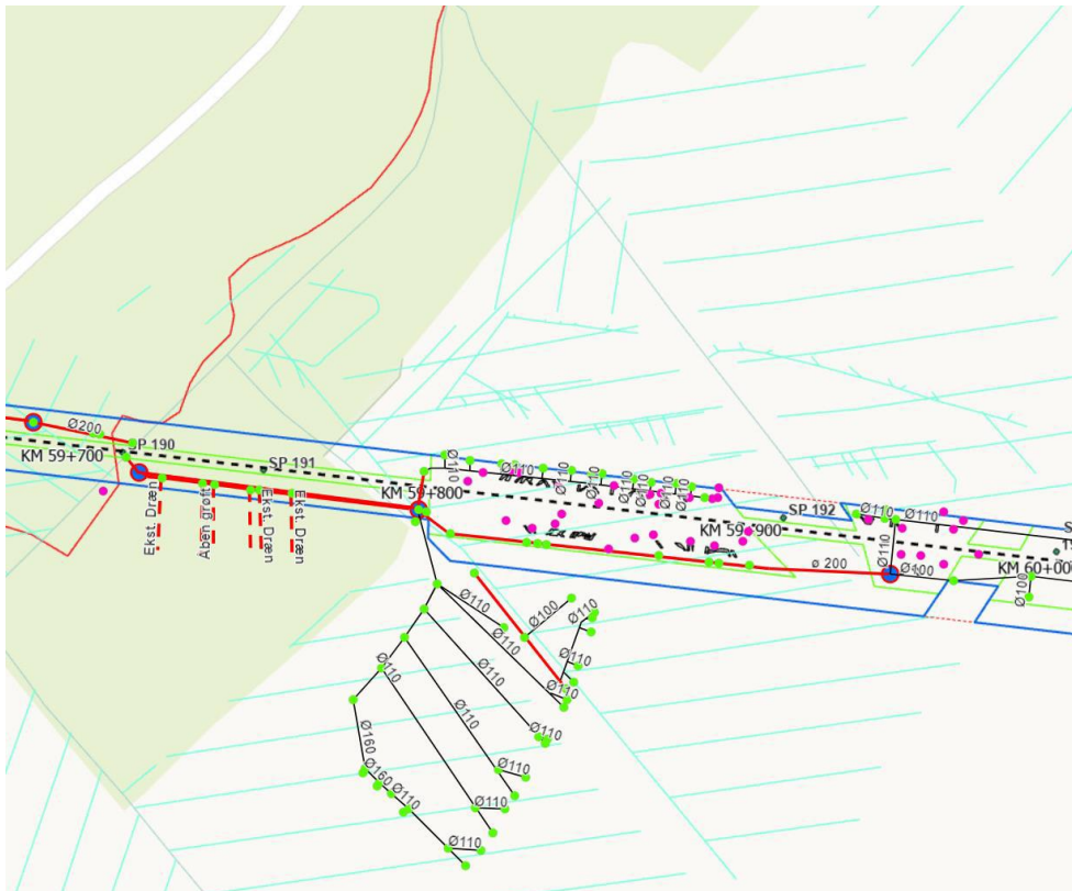
Figur 4 Dræn- og rørledninger i beskyttet mose på matrikel nr. 1b Bramstrup Hdg., Nr. Lyndelse (tyk rød linje er tætte rørledninger, tynde sorte linjer er dræn, blå cirkler med rød ring er brønde, stiplede sorte linjer er gasledningen)
