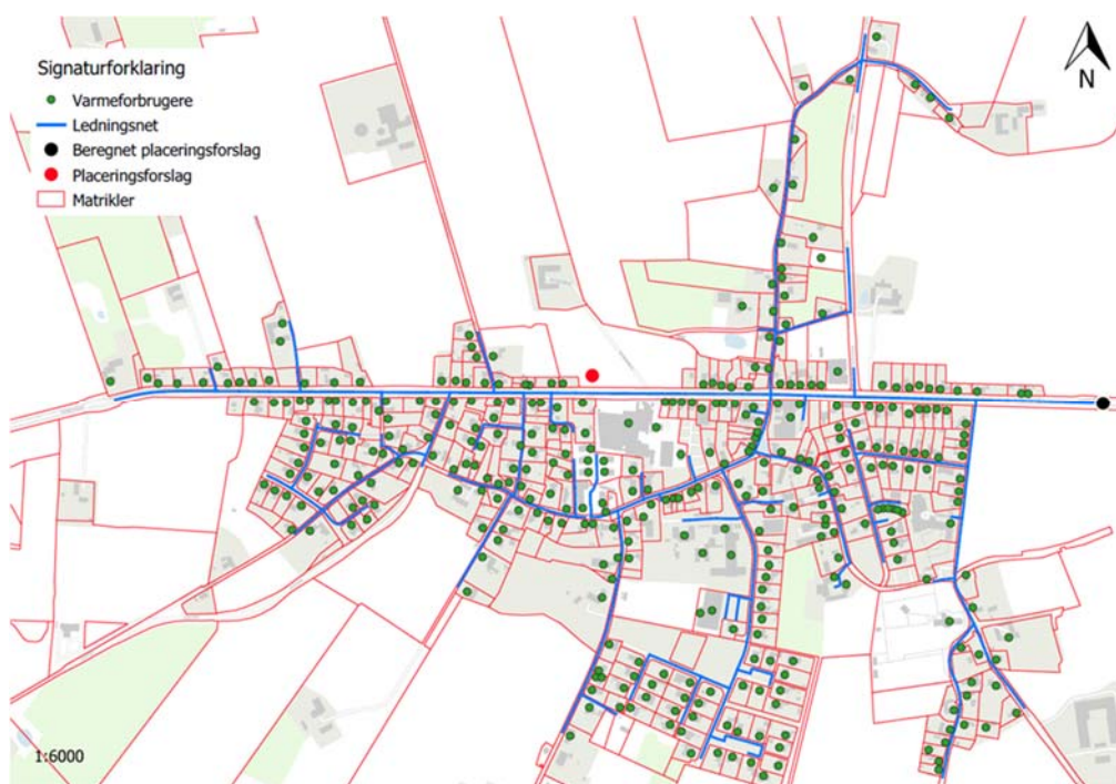
Figur 4: Oversigt over bygninger med varmebehov og ledningsnet.
