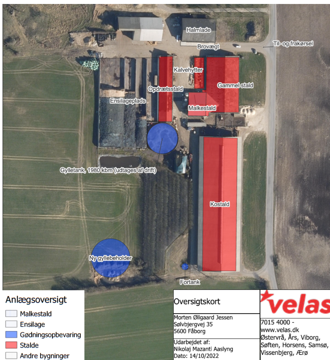
Figur 2.2: Oversigtskort over husdyrbrugets staldanlæg og gødningsopbevaringsanlæg. Rød: staldbygninger; Blå gødningsopbevaringsanlæg. Gylletanken på 1.980 m 3 , nedlægges i forbindelse med projektet og erstattes af en ny beholder længere mod syd.
