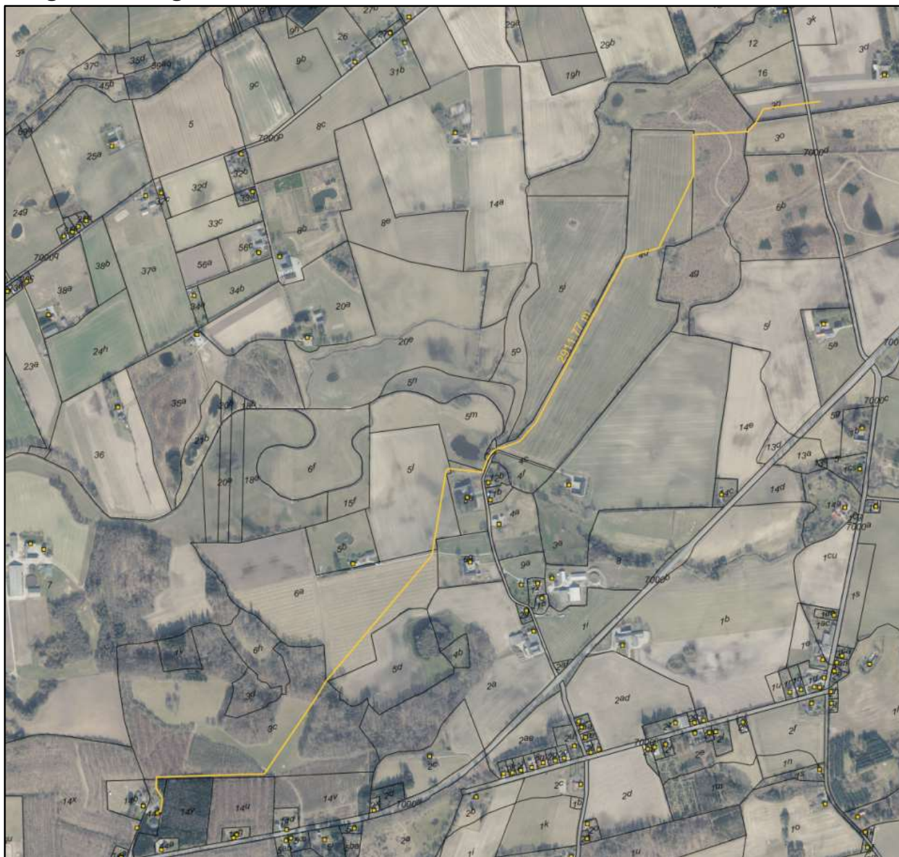
Figur 1: Oversigtskort med angivelse af det projekterede ledningstracé for råvandsledningen (gul linie), der forløber fra indvindingsboring DGU nr. 155.2257 i nord ved Boltingevej (på matr.nr. 3d, Boltinge By, Ringe) og i sydvestlig retning mod Espe Vandværk ved Assensvej. Ledningstracéet etableres delvist via styret underboring i forbindelse med krydsning af veje, vandløb, beskyttet natur og diger.
