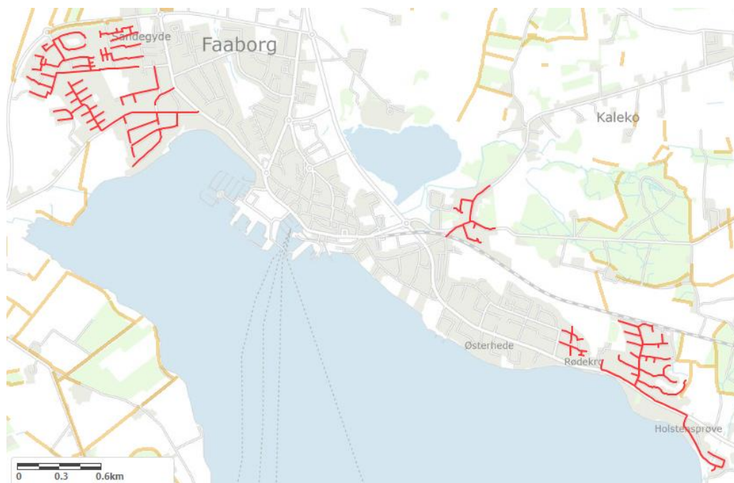
Figur 5-12 Ledningens (rød streg) placering i forhold til vejledende registrerede beskyttede sten- og jorddiger (orange streg). Kilde: Danmarks Miljøportal.
