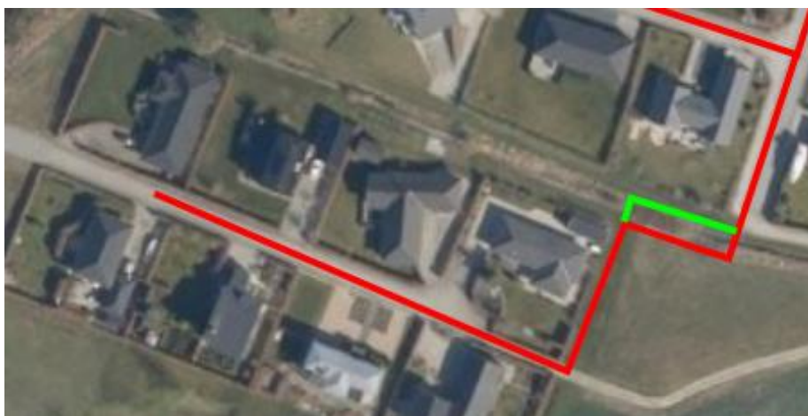
Figur 3-7 Krydsning af stendiget ved Kløvermarken. Rødt tracé er valgt, da terrænforskellen ved det grønne tracé ikke er ideel for krydsning.
