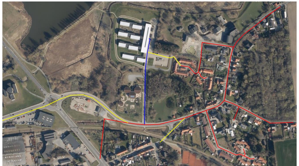
Figur 3-9 Tracéføring ved Sundbrinken. Valgte tracé markeret med rød, alternative tracéer markeret med gult og nyere Ø139,1 og Ø114,3 ledning til plejecentret er markeret med blå.
